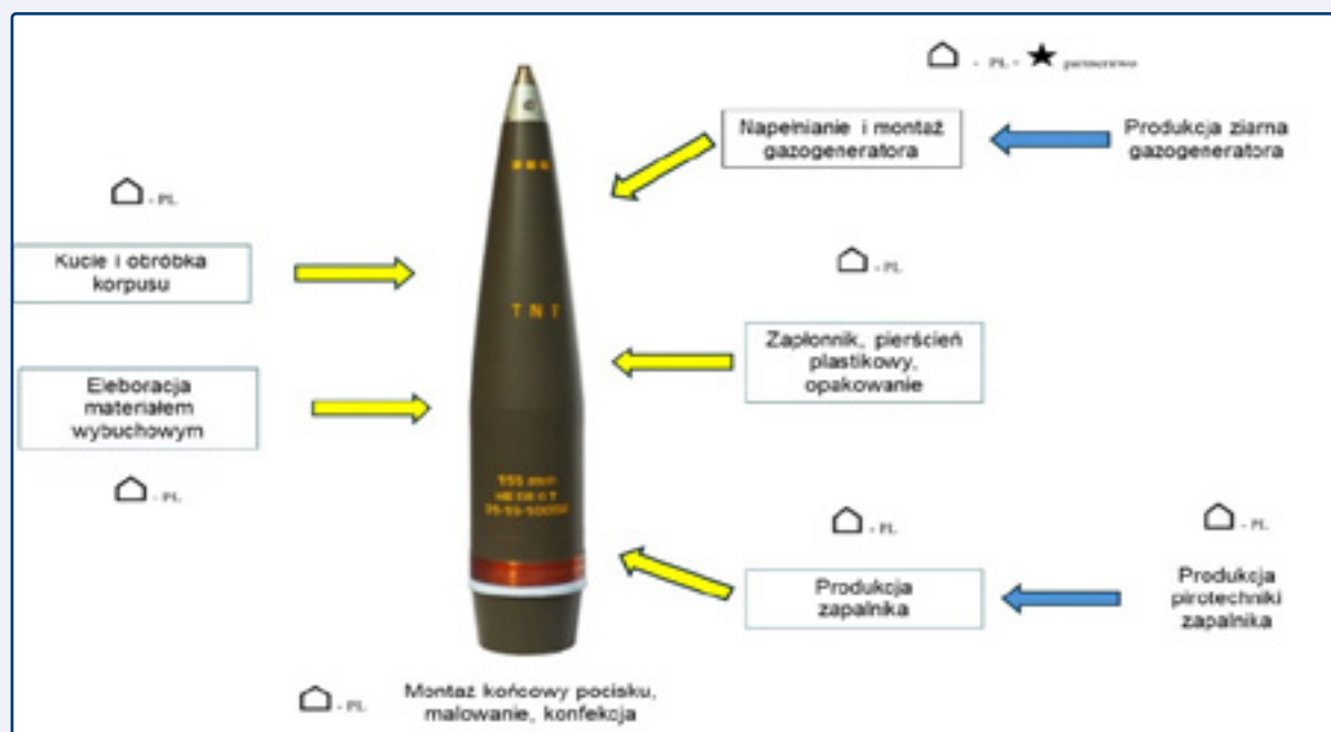
Rys. 2.2. Komponenty produkcyjne pocisku 155 mm
